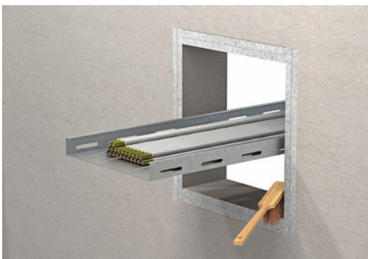
2. Kabel, Schottbereich und je Seite 100 mm vorm Schott mit BML beschichten.
